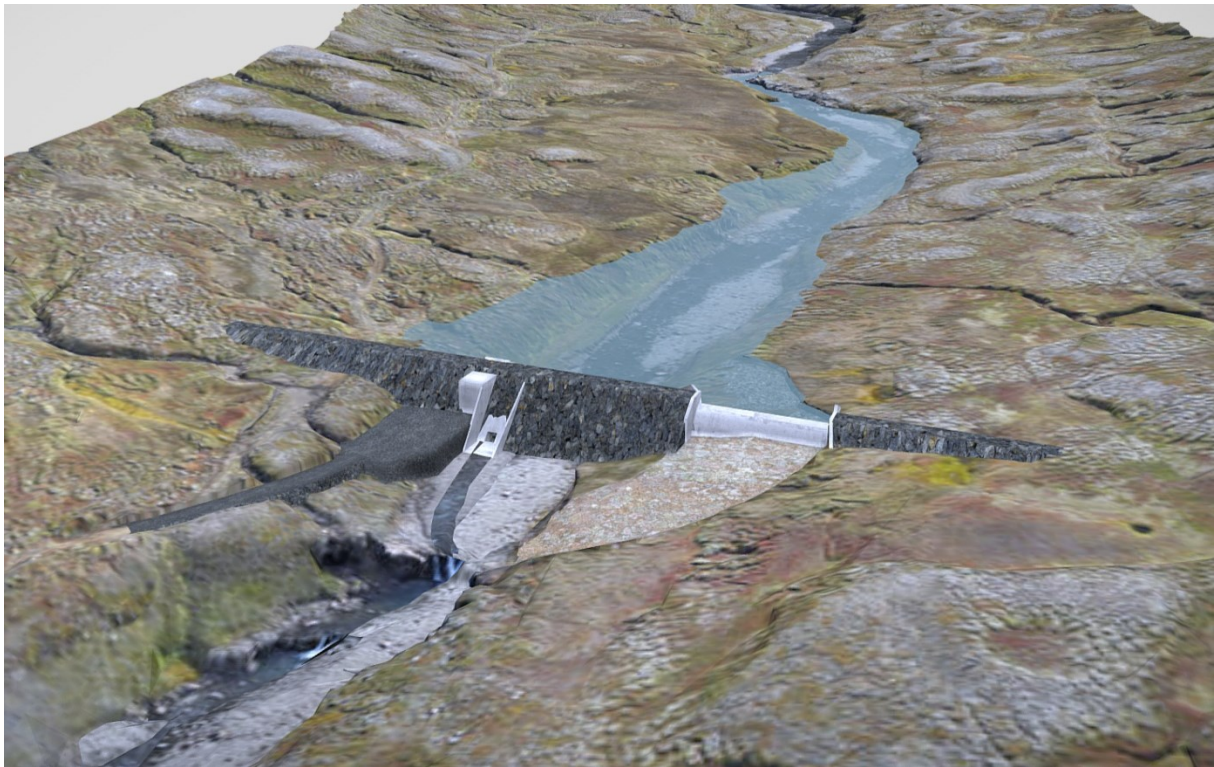
MYND 2.4 Líkanmynd af inntaksstíflu og lóni. Stíflan er einfölduð á þessari mynd, ekki er um endanlega hönnun að ræða.
